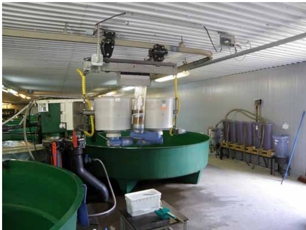
Автоматическая линия кормления рыбы (фото: Петри Хейнимаа)
