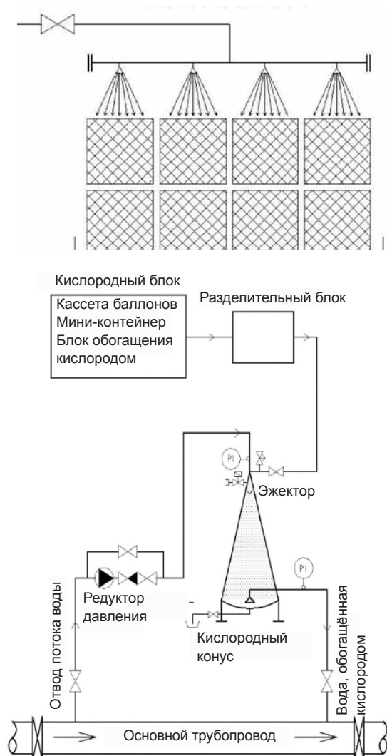
Схема 5. Принцип работы сотового распределителя и конусообразного нагнетателя кислорода
