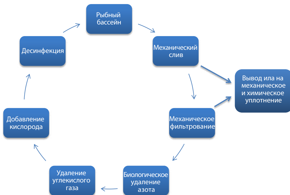
Схема 1. Основные этапы обработки воды при выращивании рыбы в системах циркуляции воды.
